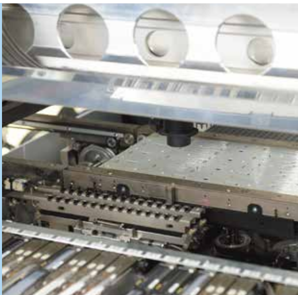
自動挿入機:アキシャル/ラジアル/ IC/異形部品の実装
