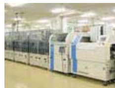
自動挿入機:アキシャル/ラジアル/ IC/異形部品の実装
